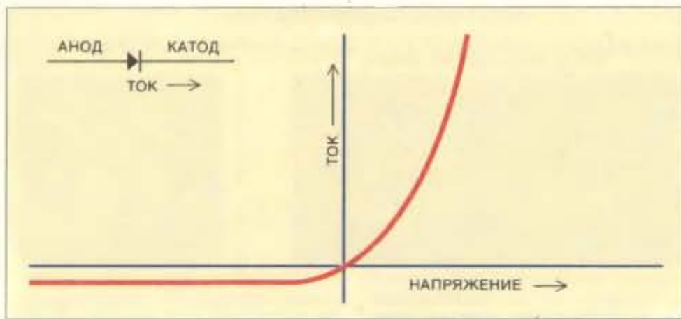
Диод пропускает электрический ток, когда напряжение на катоде ниже, чем на аноде. Здесь приведена вольт-амперная характеристика типичного диода.
